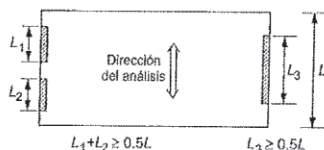
Figura 3.7 Requisito sobre muros de carga perimetrales paralelos
